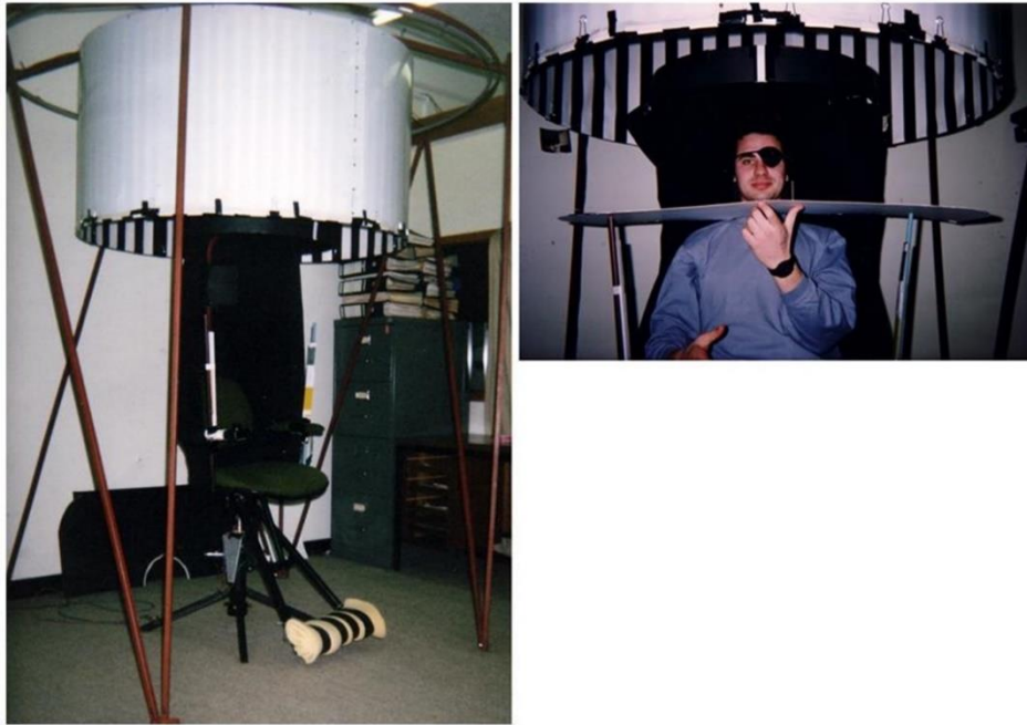
Figure 2. Chaise et tambour rotatif utilisé dans l'étude de Palmisano et Gillam (1998) pour induire une vection circulaire. Le tambour, avec des rayures verticales noires et blanches, peut être abaissé autour de la tête du participant afin que la pièce ne soit plus visible. Une fois en place, il est mis en rotation, induisant une sensation de vection circulaire. Illustration provenant de Palmisano, S., Allison, R. S., Schira, M. M., & Barry, R. J. (2015). Future challenges for vection research : Definitions, functional significance, measures, and neural bases. Frontiers in Psychology , 6. DOI : 10.3389/fpsyg.2015.00193.
