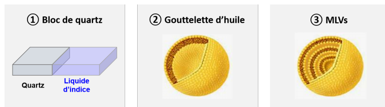
FIGURE 2.3 – Echantillons modèles étudiés dans ce chapitre pour caractériser le signal PTHG sur des interfaces verticales : un bloc de quartz, une gouttelette d'huile et une vésicule lipidique multilamellaire (MLV).
