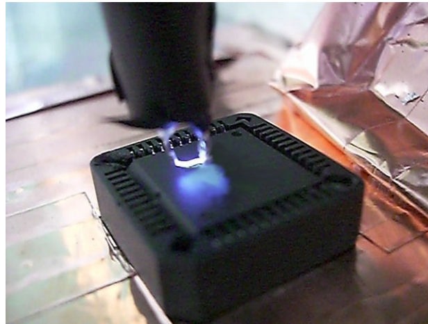
FIGURE 1.4 – Allume gaz utilisé comme injecteur EM dans [SH07].
