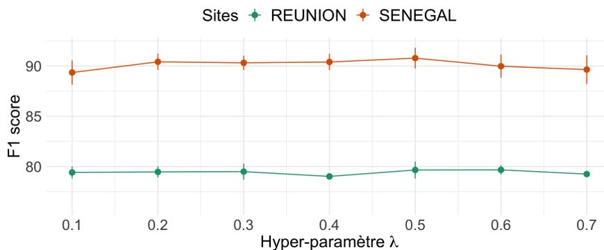
Figure 3.14 – Analyse de sensibilité du modèle *HOb2sRNN* à la variation de l'hyper-paramètre  $\lambda$  associé à la perte des classifieurs auxiliaires. L'écart-type est affiché sous forme de barre d'erreur.
