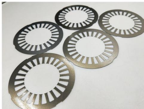
FIGURE 1.7 – Tôles laminées et découpées d'un stator
