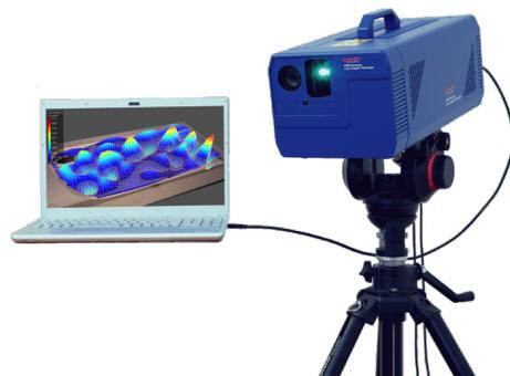
(b) Vibromètre laser doppler à balayage
