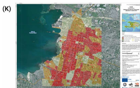
SERTIT : Catalogue des bâtiments endommagés (produite le 18/01/2010) La carte montre les niveaux de dommages estimés à partir des structures endommagées observables par photo-interprétation. Les données sont agrégées par l'intermédiaire d'un maillage hétérogène créé à partir de la découpe de polygone en fonction du linéaire routier.
