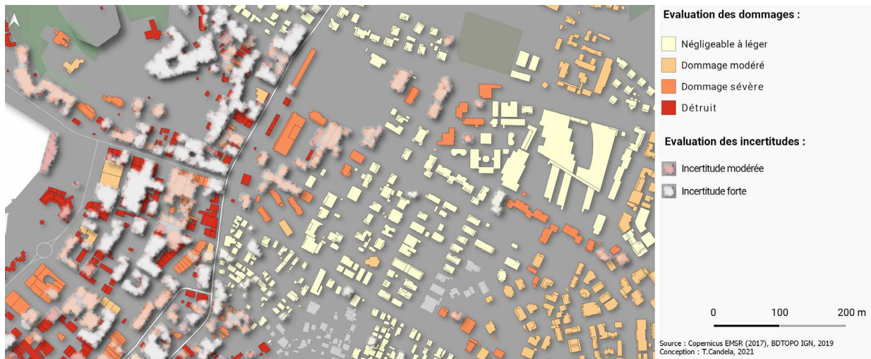
Figure 151 : Évaluation des dommages et représentation de l'incertitude attributaire à partir des blocs de bâtiments
