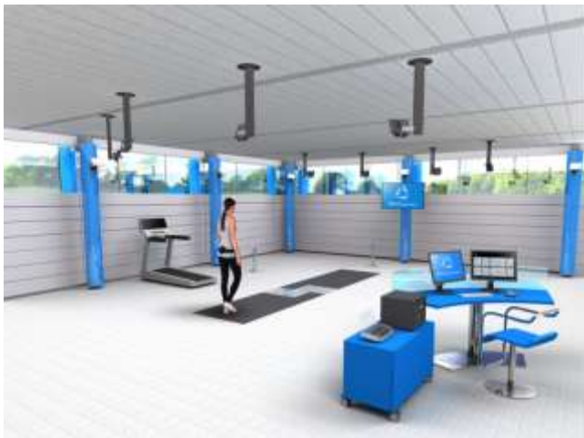
Figure 4. La configuration d'un laboratoire de mouvement typique : 1) caméras vidéo avec stroboscopes infrarouges, 2) couloir de marche instrumenté avec des plateformes de force intégrées, 4) système EMG de surface avec transmission sans fil, 5) caméras vidéo analogiques / numériques, 6) poste de travail informatique.
