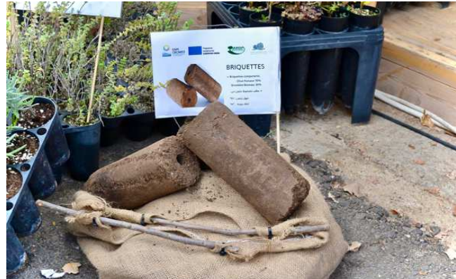
Briquettes fabriquées à partir de la biomasse collectée dans les forêts de chêne et de grignons d'olives. Crédit : Amani Fares, 19/05/2016.
