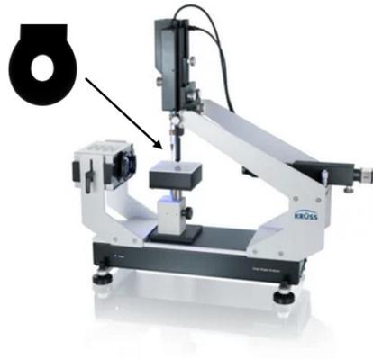
FIGURE II.21 – Tensiomètre à goutte pendante (Krüss, DSA25E, Allemagne, source : *kruss.com*).
