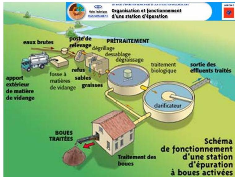
FIGURE I.1 – Schématisation du principe de fonctionnement d'une station d'épuration (extrait de eduterre.ens-lyon).
