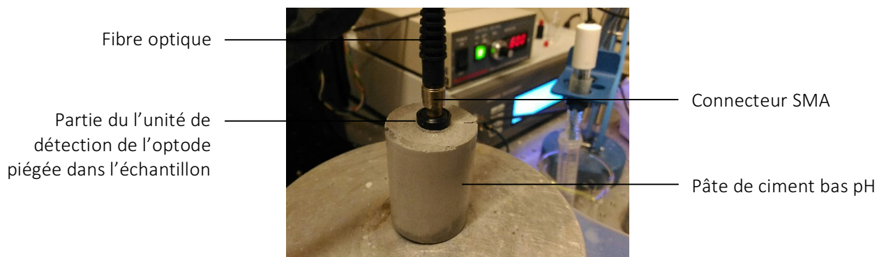
Figure II - 61 : Essai de mesure du pH in situ dans une PCD bas pH. L'optode a été coulée dans la PCD
