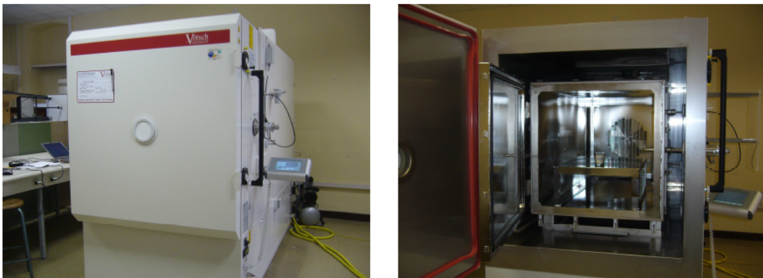
FIGURE 2.26 – Chambre VCE 100 disponible au LCE (Marseille) dans laquelle les capteurs SAW ont été testés.
