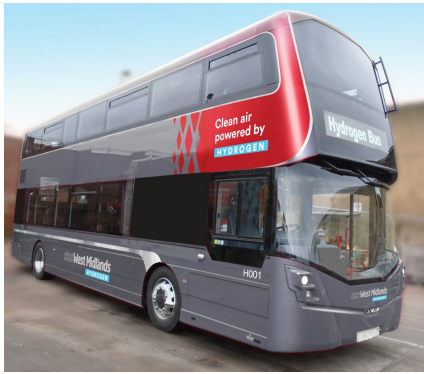
(a) Bus électrique PEMFC - West Midlands Hart et al. (2020)
