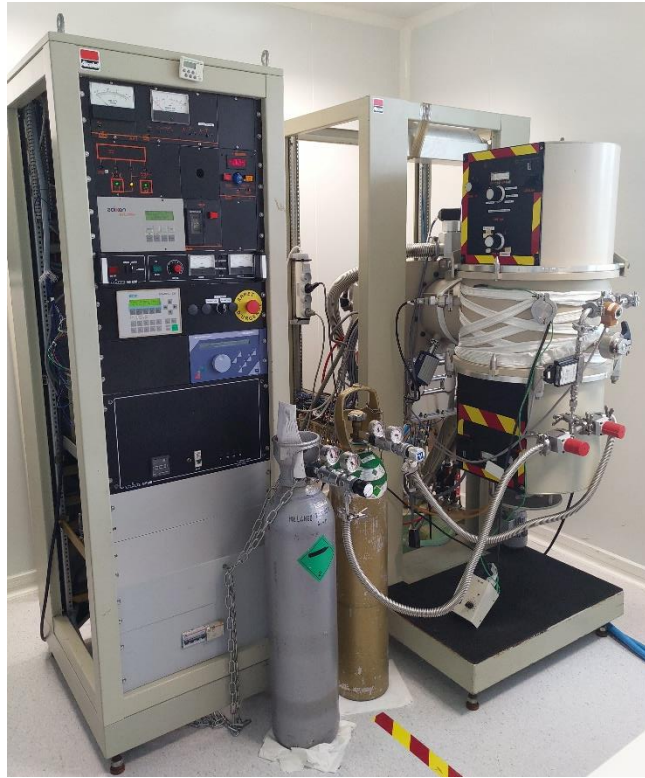
Figure A-3 : Bâti de dépôt Alcatel CIT.
