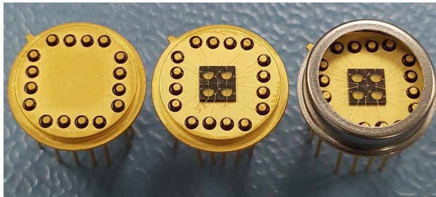
Figure C-2 : Différentes étapes de réalisation du microcapteur. (a) Boîtier TO8 nu, (b) micropuce montée avec les broches soudées. (c) microcapteur avec collier prêt à être caractériser.
