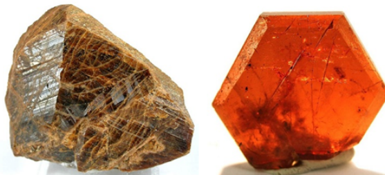
Fig. 1-9 : Photographies des deux principaux minéraux exploités pour l’extraction des Terres Rares : la monazite (à gauche - Lavinsky, 2010b) et la bastnäsite (à droite - Lavinsky, 2010a).
