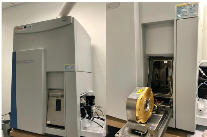
Fig. 3-10 : Photos du Triple Quadripôle ICP-MS de la marque Thermo Scientific® (iCAP TQ-ICP-MS).
