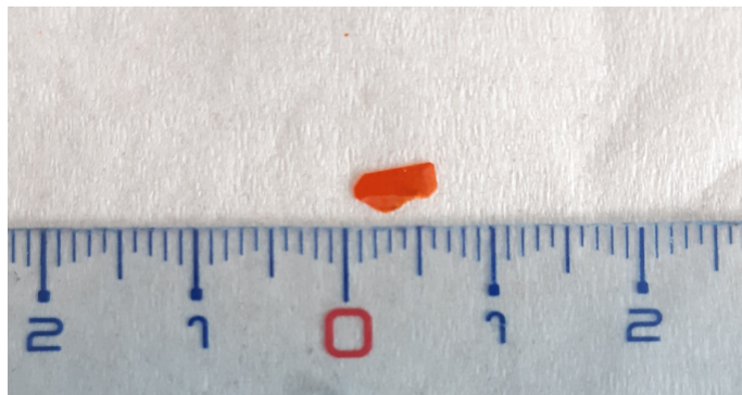
FIGURE 2.3 – Photo d'un cristal de PEPI synthétisé par refroidissement lent.
