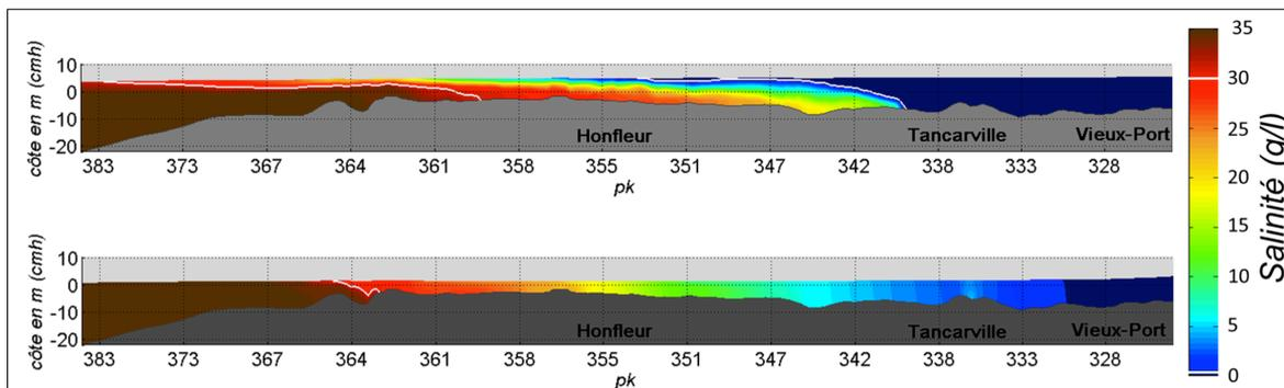
Figure II.13 : Illustration du gradient vertical de salinité pour deux conditions hydrologiques contrastées. En haut : basse mer de morte eau, en crue (débit :  $1076 \text{ m}^3 \cdot \text{s}^{-1}$ , coeff. : 29, le 13 mars 2007). En bas : pleine mer de vive eau, en étiage (débit :  $248 \text{ m}^3 \cdot \text{s}^{-1}$ , coeff. : 94, le 2 août 2007) (Lemoine et al., 2015)
