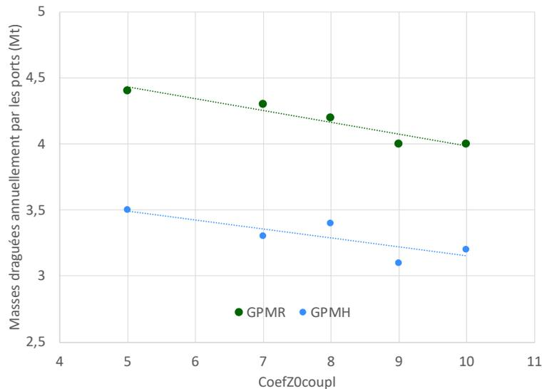
Figure III.3 :Évolution des masses draguées par le GPMR et le GPMH en fonction de la valeur de  $\text{Coef}Z_{0\text{coupl}}$ . Ces résultats sont issus de simulation réalisées avec une ancienne version du modèle sédimentaire et ne sont pas directement comparables aux résultats présentés dans le reste du manuscrit
