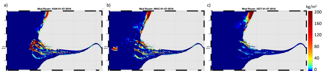
Figure V.4 : Moyenne pendant le mois de juillet 2018 des distributions sur le fond des vases immergées par le GPMR au Kannik (a), à Machu (b) ou Octeville R (c) de juillet 2009 à juillet 2018 (en  $\text{kg/m}^2$ )
