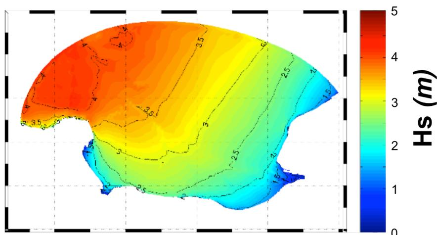
Figure II.5 :Illustration de la propagation d'une houle d'ouest dans la baie de Seine, représentation de la hauteur significative des vagues le 1<sup>er</sup> mars 2008 (simulation WaveWatch3 projet Seine-Aval MODEL)
