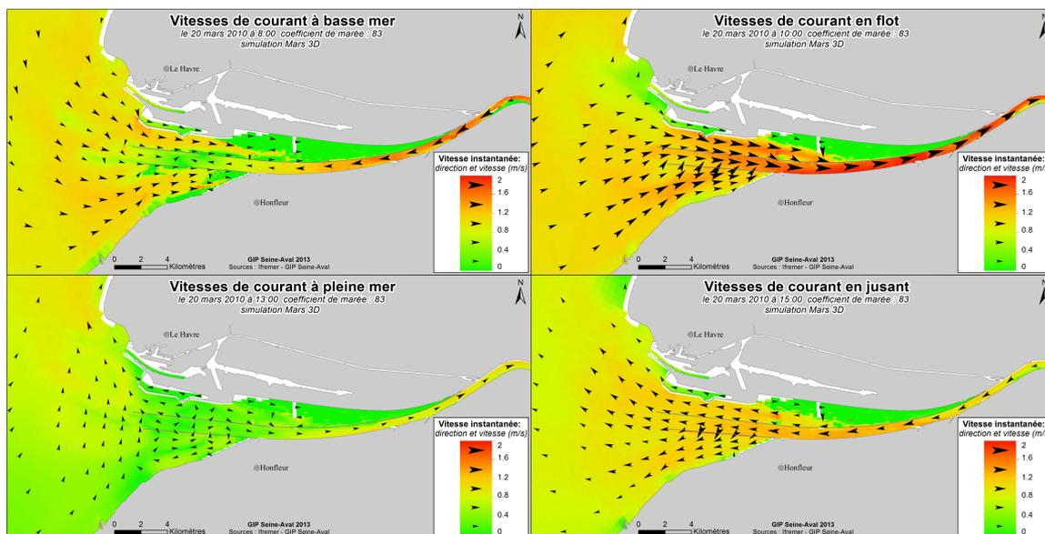
Figure II.9: Répartition des vitesses de courants au niveau de l'embouchure pour différents moments de la marée en conditions moyennes (débit : 397m<sup>3</sup>.s<sup>-1</sup>, coeff. de marée 83) vitesses moyennées sur la hauteur d'eau – Modélisation MARS 3D (Lemoine et al., 2015)
