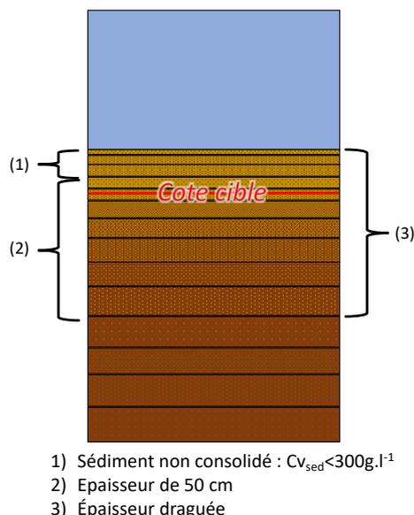
Figure III.2: Illustration de l'épaisseur de sédiment draguée selon les différents couches du modèle sédimentaire
