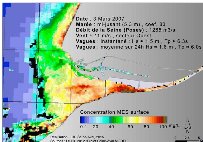
Figure II.22 : Distribution spatiale des concentrations en MES de surface mesurée par le satellite MODIS le 3 mars 2007 (données qualitatives) ; marée : mi-jusant, débit :  $1285 \text{ m}^3 \cdot \text{s}^{-1}$  (in Le Hir et al., 2012)
