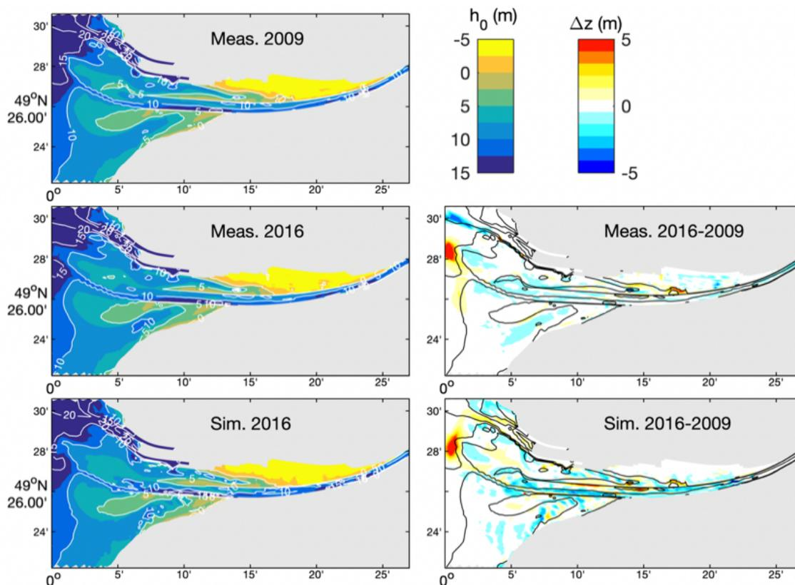
Figure III.9: Évolution morphologique de l'estuaire aval entre 2009 et 2016. A Gauche : Bathymétries  $h_0$  (cote relative au niveau moyen de la mer); à droite : différentiels bathymétriques  $\Delta z$ , mesurés et simulés (d'après Grasso et al, 2020)
