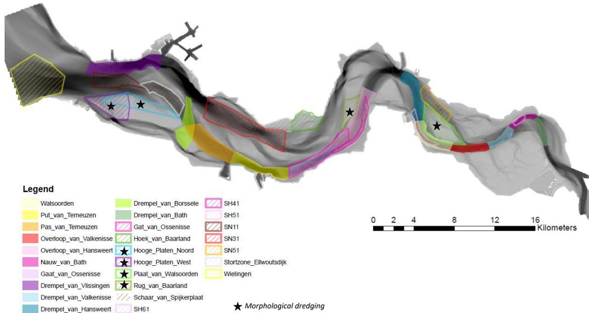
Figure I.4 : Localisation des zones de dragages et de clapages de l'Escaut utilisées depuis 2010 avec la technique flexible dumping. Les zones hachurées représentent les zones de clapages. Les zones avec une étoile correspondent aux sites sur lesquels des immersions utilisant la technique morphological dredging sont réalisées (VNSC 2016 in Cox, 2018)
