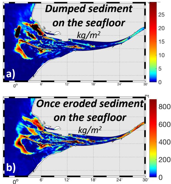
Figure IV.18 : Répartition des sédiments marqués sur le fond après 3 ans : a) sédiments clapés par le port de Rouen et b) sédiment mobile ("once eroded"), après 3 ans de simulation
