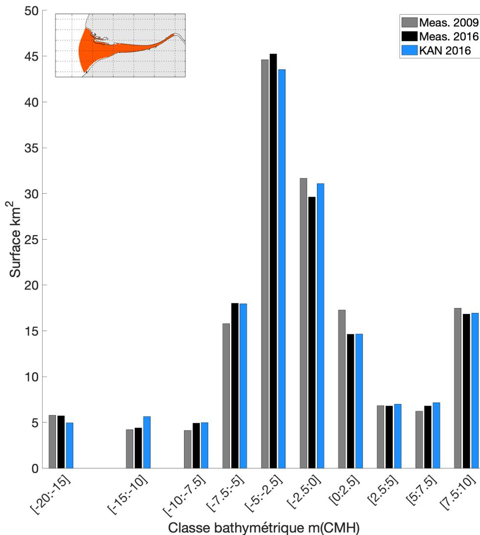
Figure III.12 : Distribution des surfaces par classes bathymétriques  $h_0$  (mCMH) mesurées et simulées sur les périodes de septembre 2009 à septembre 2016. L'emprise de calcul est indiquée sur la carte miniature
