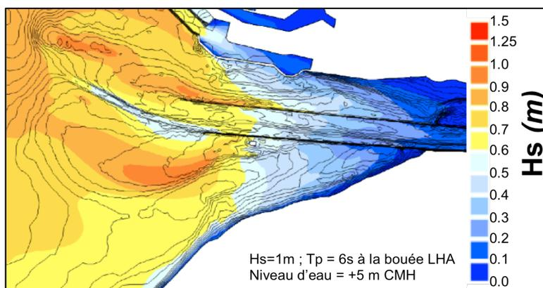
Figure II.7: Illustration de la propagation d'une houle d'ouest à l'embouchure, Représentation de la hauteur significative des vagues le 1<sup>er</sup> mars 2008 (simulation WaveWatch3, projet Seine-Aval MODEL)
