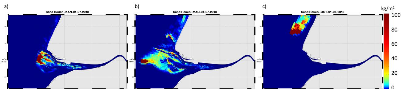
Figure V.3 : Moyenne pendant le mois de juillet 2018 des distributions sur le fond des sables immergés par le GPMR au Kannik (a), à Machu (b) ou Octeville R (c) de juillet 2009 à juillet 2018 (en  $\text{kg/m}^2$ )
