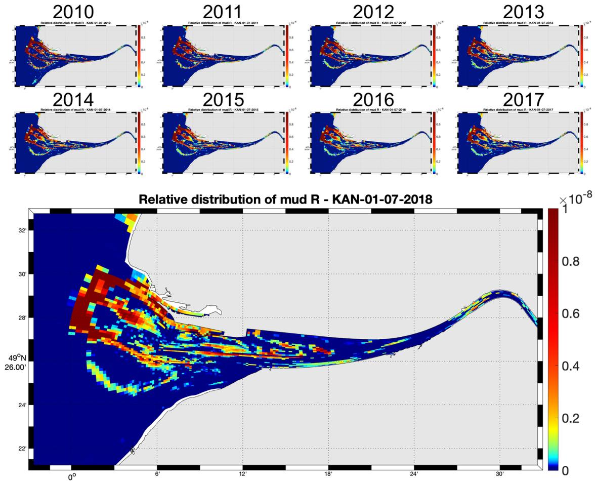
Figure IV.14 : Moyenne pendant le mois de juillet de chaque année des distributions relatives sur le fond des vases immergées par le GPMR au Kannik de juillet 2009 à juillet 2018 (en  $\text{kg}/\text{m}^2/\text{kg}$ ). Chaque année, la distribution relative est obtenue en divisant les masses par unité de surface par la masse totale clapée depuis le début. L'échelle de couleur est la même pour toutes les cartes
