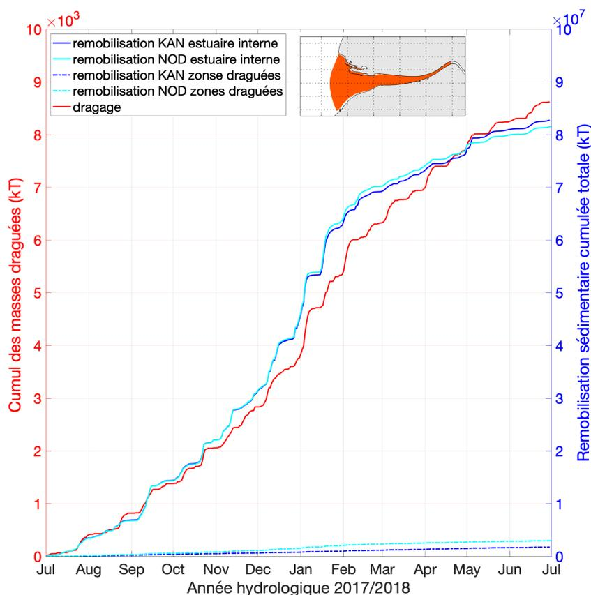
Figure IV.25: Évolution temporelle *i*/ de la remobilisation sédimentaire cumulée totale (sables et vases) intégrée sur la zone de l'estuaire interne (ligne pleine) et au niveau des zones draguées (ligne tiretée), et *ii*/ du cumul des masses draguées par les deux ports (sables et vases) (rouge) sur l'année hydrologique 2017/2018 pour les scénarios KAN (bleu) et NOD (cyan). L'emprise de l'estuaire interne est rappelée dans la vignette
