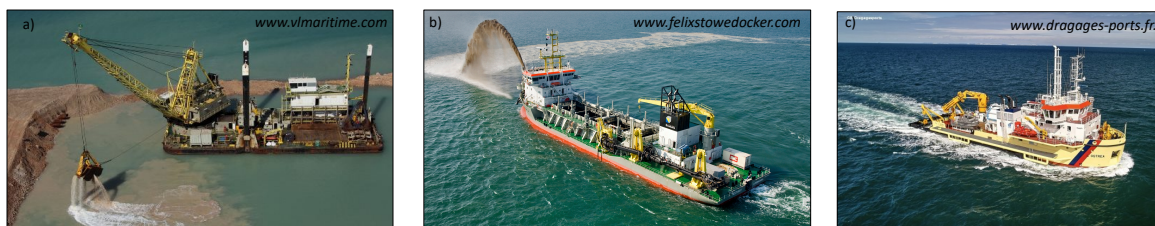
Figure 1.1: Illustration des différents types de dragage. a) dragage mécanique: drague stationnaire à benne; b) dragage hydraulique: drague aspiratrice en marche rejetant dans l'air la mixture eau-sédiment ("rainbowing") ; c) dragage par injection d'eau : l'Ostrea, drague du GIE -Dragages-Ports utilisées par le port de Bordeaux. (sources des illustrations précisées sur les photos)
