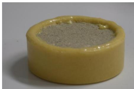
Figure 4-29 : L'échantillon SRC  $\phi 5H2$  pour l'essai de diffusion du CO<sub>2</sub>
