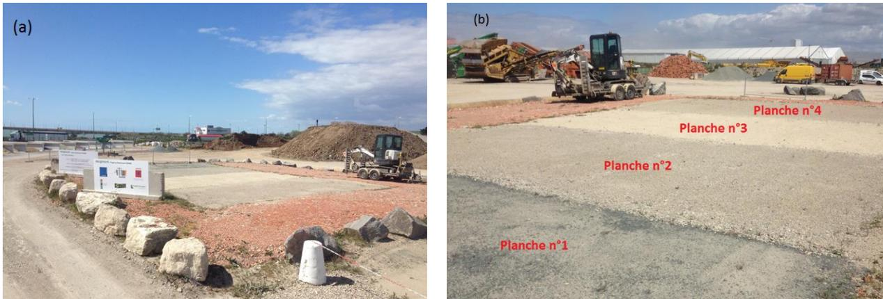
Figure 1-17 : (a) Vue d'ensemble de la plateforme expérimentale ; (b) Planche 1 : Grave dioritique 0/20 mm, Planche 2 : Grave Recyclée 0/31,5 mm, Planche 3 : Grave calcaire 0/31,5 mm et planche 4 : Grave recyclée 0/31,5 mm + 20% de sable de terre cuite 0/6 mm
