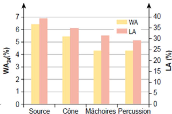
Figure 1-9 : Absorption d'eau à 24 heures (WA<sub>24</sub>) et résistance à la fragmentation (LA) pour le GBR source et le GBR concassé avec différents types de concasseur : giratoire, à mâchoire et à percussion [Hamard et Cazacliu, 2014]
