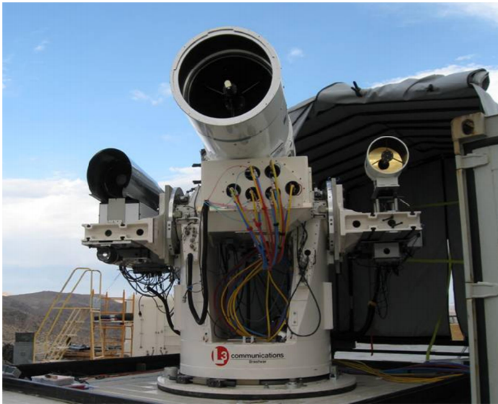
FIGURE 1.33 – Photographie du dispositif de combinaison incohérente par superposition spatiale Laser Weapon System (LaWS) et du télescope astronomique utilisé pour l'alignement des faisceaux. [82]
