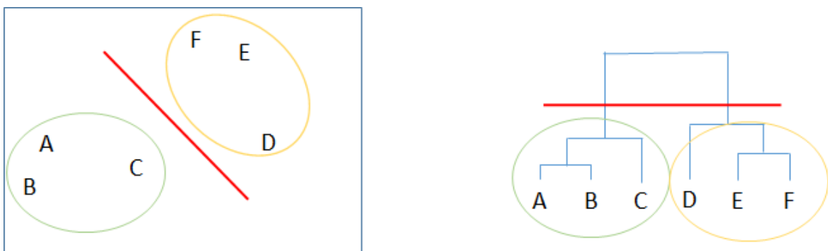
FIGURE 2.17 Exemple de dendrogramme avec ligne de séparation des clusters.
