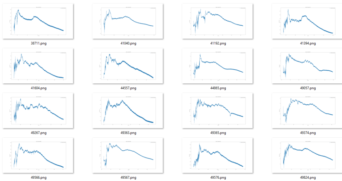
FIGURE 4.58 Echantillons de signaux d'impact du cluster 3 du SOM.
