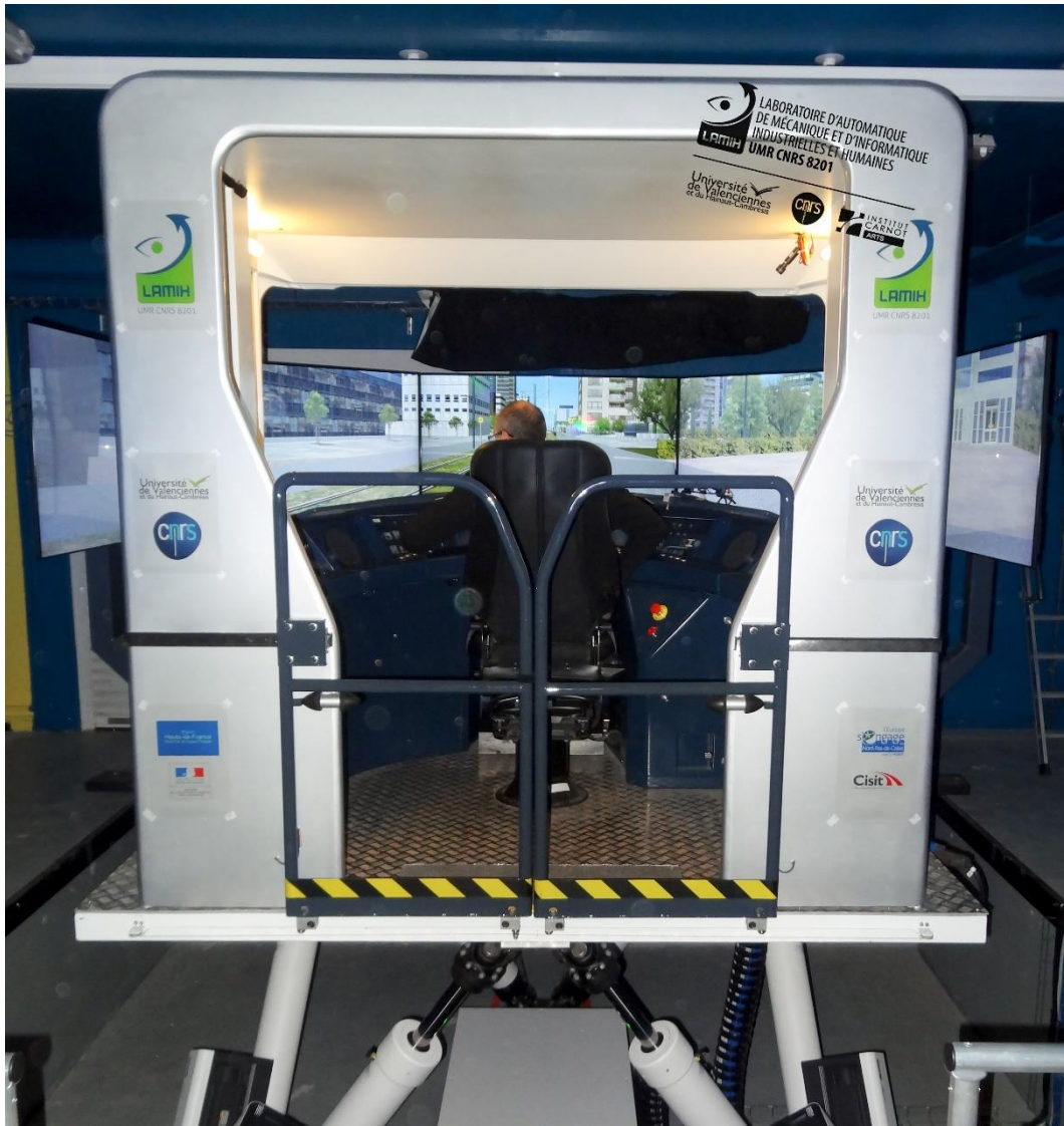
Figure 21 : Simulateur de conduite PSCHITT-Rail du LAMIH
