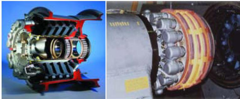
**Figure I-1-o** : Photographies présentant des disques de frein en composite C/C [M-B. 2008]
