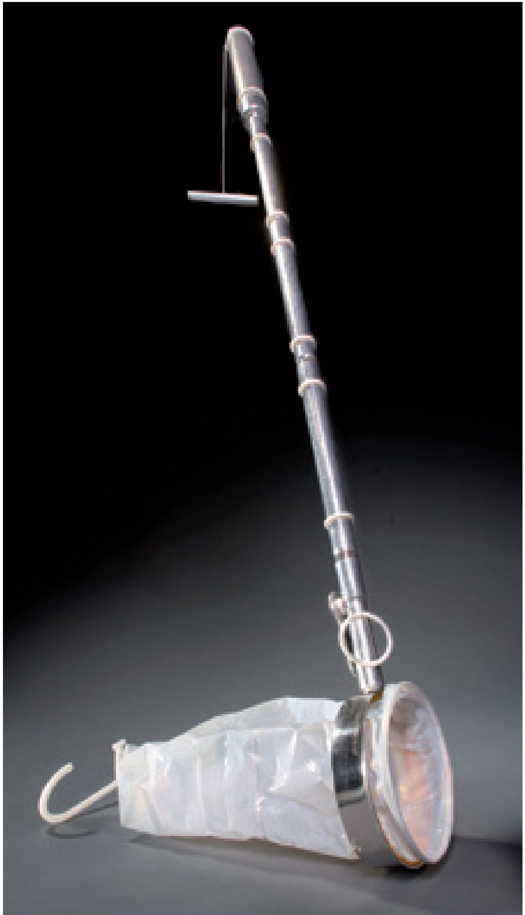
ILLUSTRATION 38 — Outil pour prélever des échantillons de sol lunaire utilisé par les astronautes des missions Apollo 11 à 15, © Éric Long, Smithsonian National Air and Space Museum.
