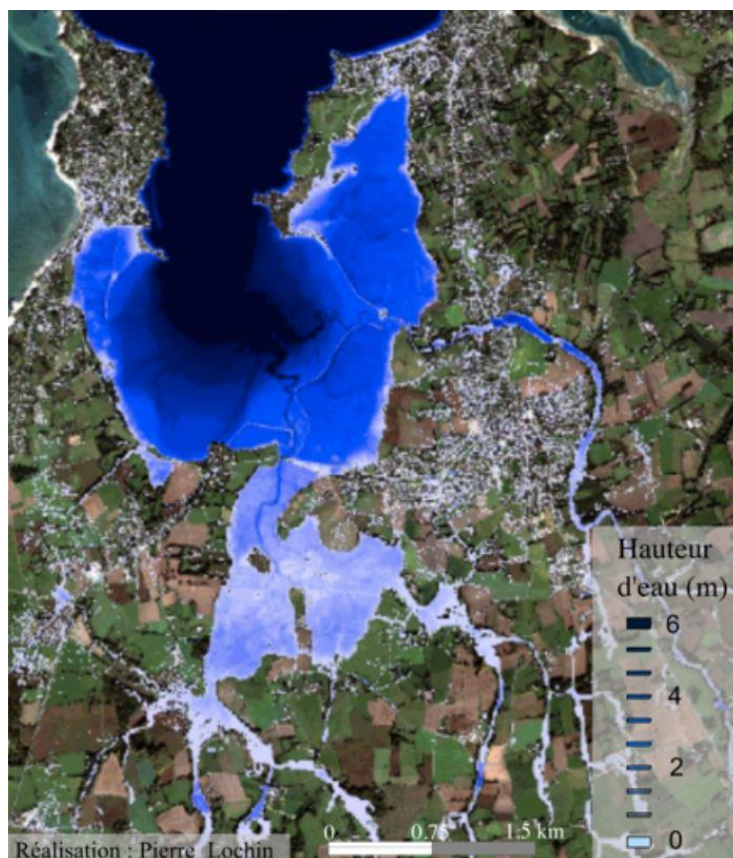
Figure 161. Extrait de la simulation des hauteurs d'eau en baie de Beaussais, réalisée avec TUFLOW. Source : Lochin (2020).
