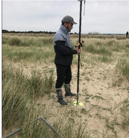
Figure 91. Acquisition des points de contrôle au sol par l'intermédiaire d'un SMNSD. Source : Mury *et al.* (2019b).
