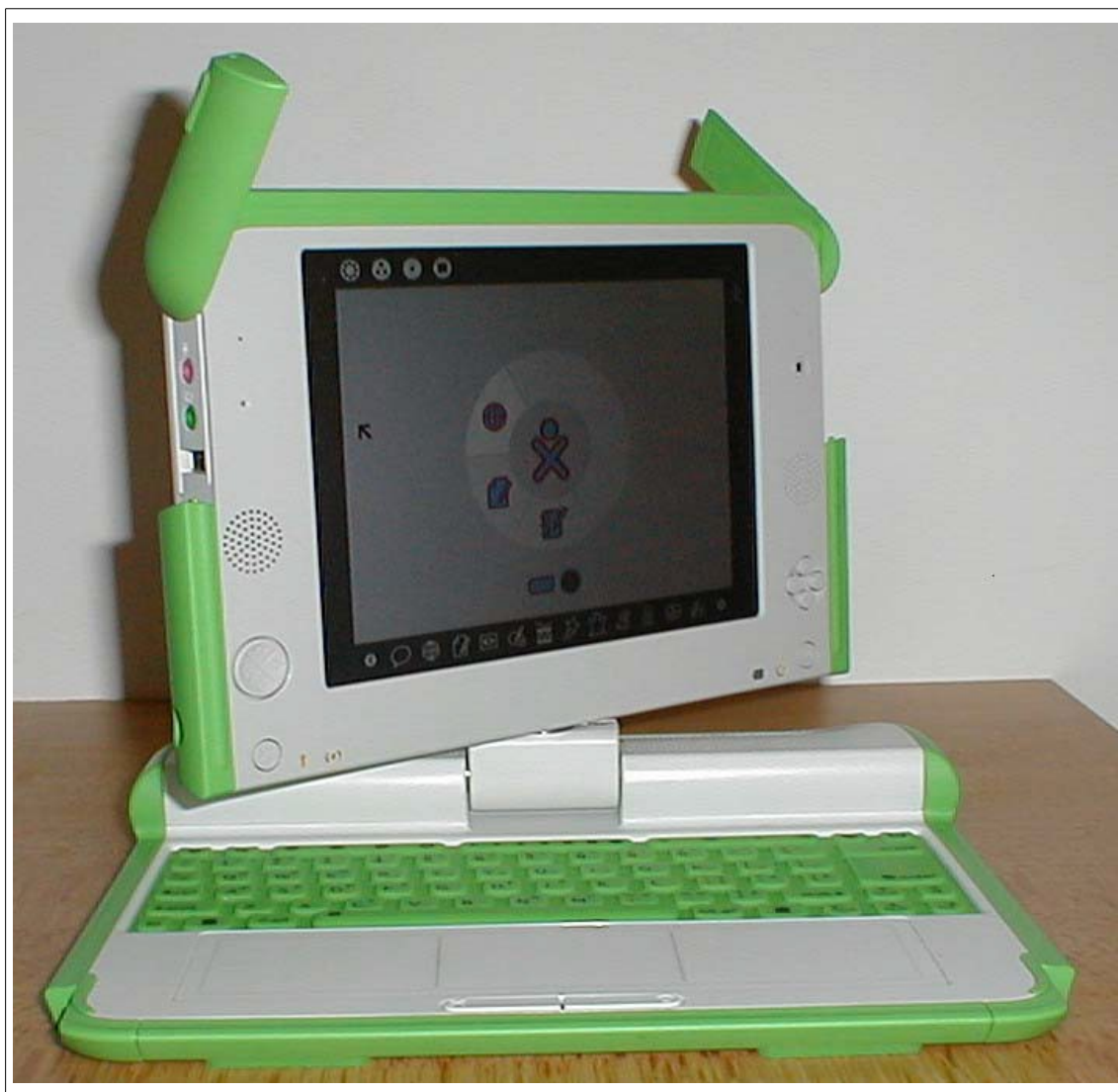
Figure 24 : Prototype du XO du projet OLPC 109
