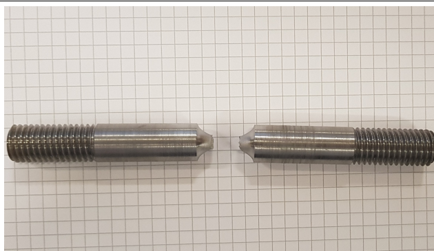
FIGURE 1.16 – Éprouvette axisymétrique entaillée après rupture - Rayon d'entaille R_e = 4
