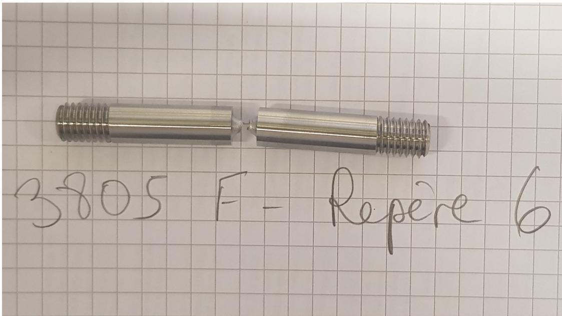
FIGURE 1.44 – Eprouvette axisymétrique entaillée de rayon d'entaille  $R_e = 1\text{mm}$  rompue après essai.
