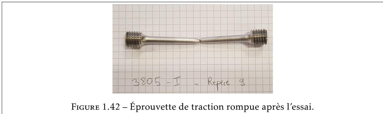
La courbe conventionnelle de traction obtenue est présentée figure 1.43. Les valeurs obtenues en  $R_{p0,2}$  et  $R_m$  sont bien conformes aux valeurs observées pour ce type d'acier fabriqué par compaction isostatique à chaud.
