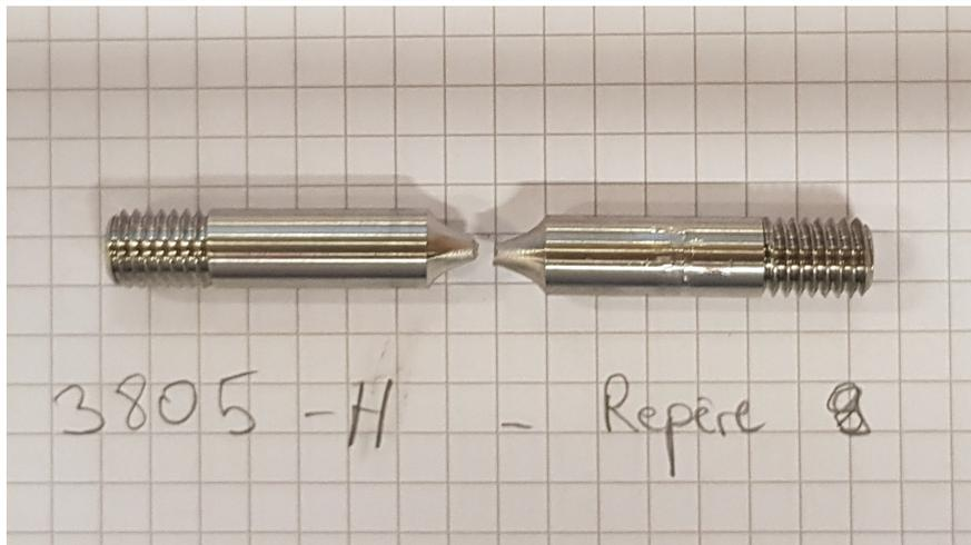
FIGURE 1.46 – Epreuve axisymétrique entaillée de rayon d'entaille  $R_e = 4\text{mm}$  rompue après essai.
