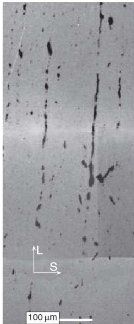
FIGURE 2.14 – Modes de coalescence sous chargement vertical - Coalescence en colonnes aussi appelée "Necklace coalescence" (tirée de BENZERGA, 2000).
