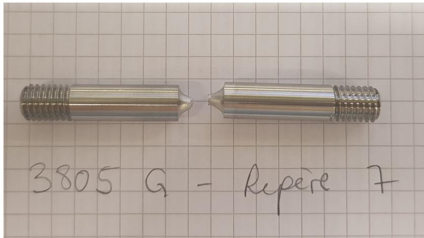
FIGURE 1.45 – Eprouvette axisymétrique entaillée de rayon d'entaille  $R_e = 2\text{mm}$  rompue après essai.
