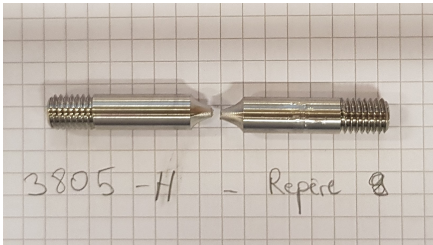
FIGURE 1.46 – Epreuve axisymétrique entaillée de rayon d'entaille R_e = 4\text{mm} rompue après essai.
