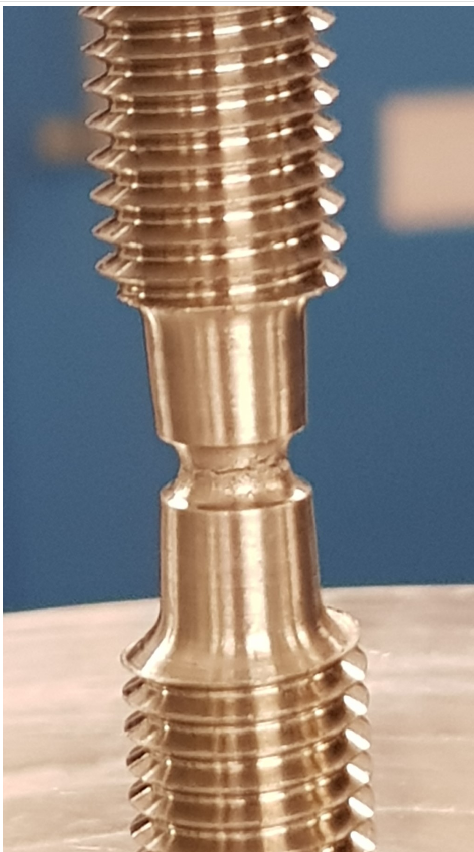
FIGURE 2.21 – Cliché de l'éprouvette axisymétrique entaillée chargée jusqu'au Cycle 8 - La fissure en bord d'entaille est visible à l'oeil nu.
