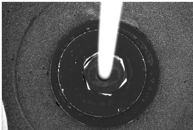
FIGURE 2.26 – *Positionnement de l'outil de mise sous pression dans le trou carotté*
