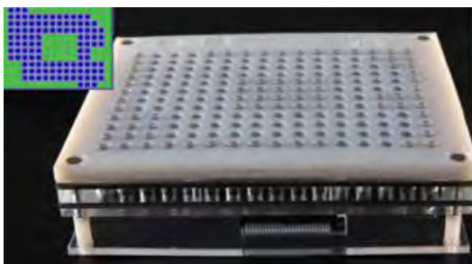
Figure 23 : Plan d'une chambre affiché sur le dispositif étudié par Zarate et al. (2017)
