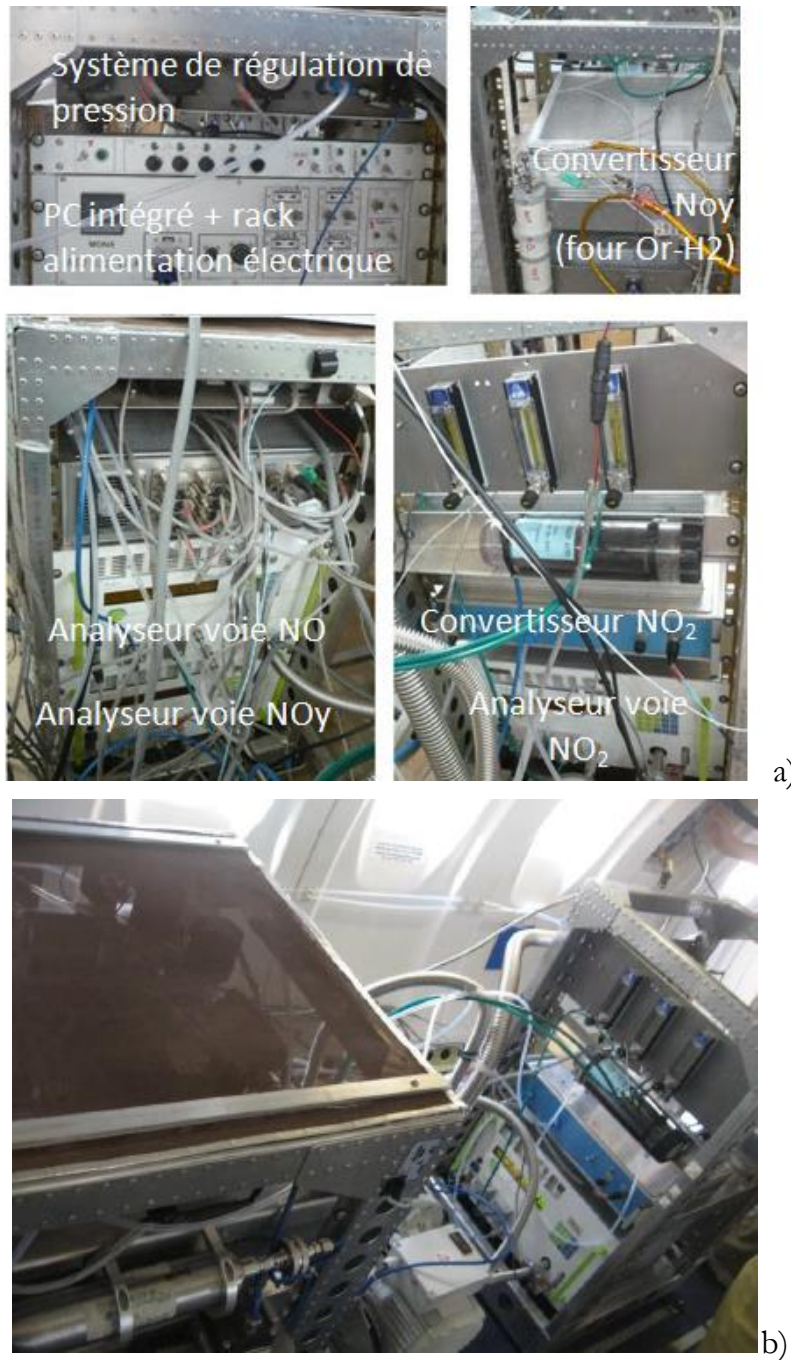
Figure II.4: a) Instrument MONA développé au LISA et avec la DT-INSU. b) MONA à bord de l'ATR-42.
