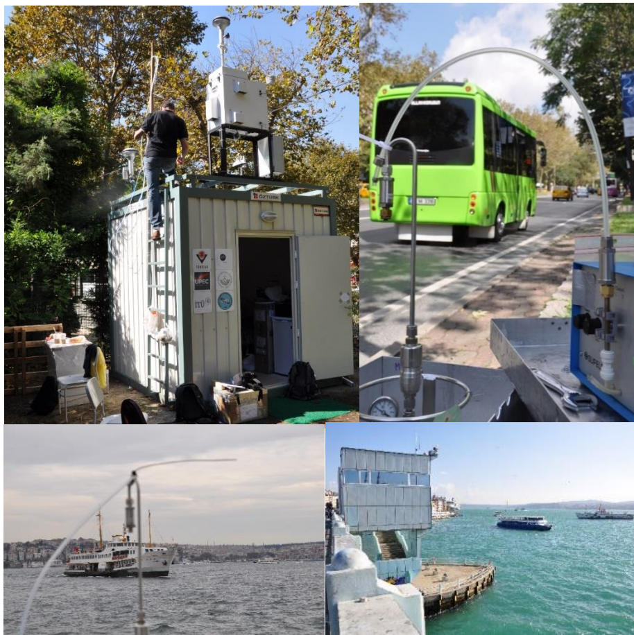
Figure II.9: Site de mesure (gauche) et prélèvements ponctuels par canister ou cartouche sur un site trafic (haut-droite) et à proximité des couloirs maritimes (bas) dans la mégapole d'Istanbul.
