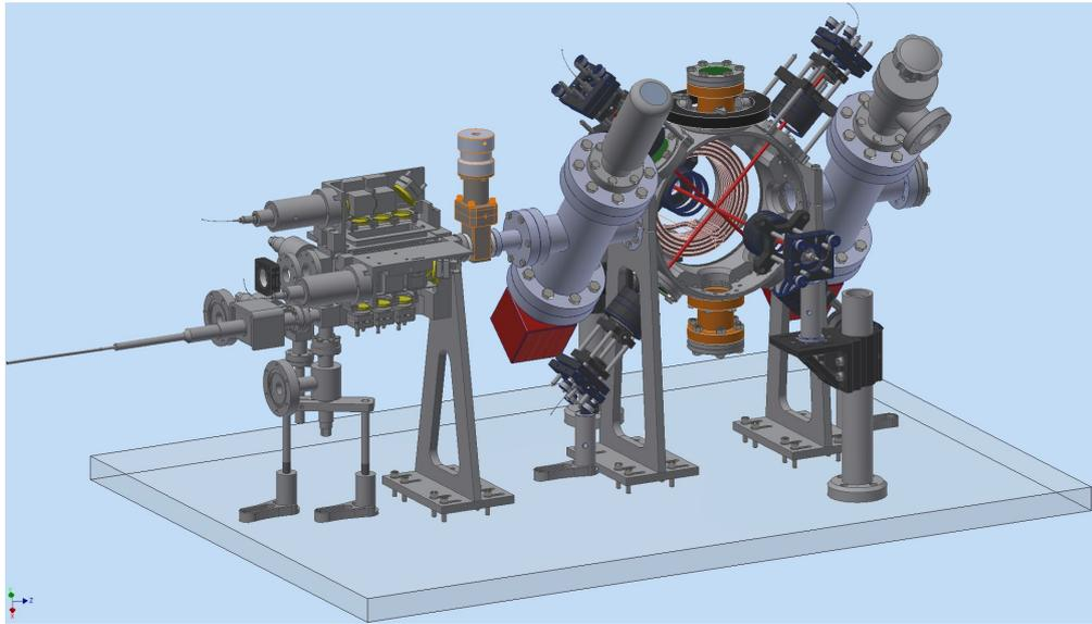
FIGURE 5.2 – Système à vide : notre système est composé de deux enceintes à vide qui sont connectés par un tube différentiel. Notre condensat sera créé dans la chambre de science (pression de  $2 \times 10^{-11}$  mbar).
