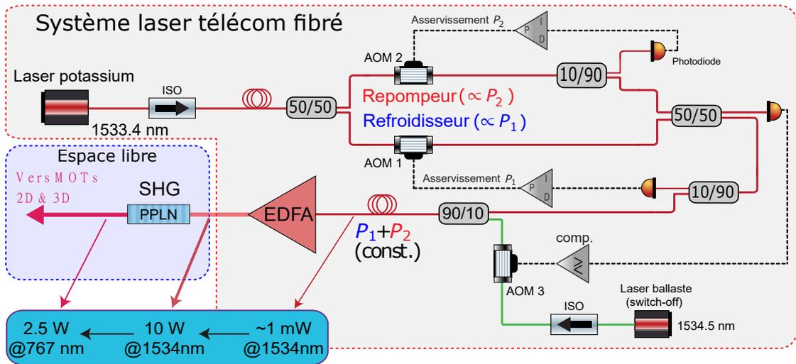
FIGURE 2.2 – Système fibré du système laser D2. Nous générons toutes les fréquences de refroidissement du potassium dans la partie fibrée à basse puissance avant amplification et doublage en fréquence.
