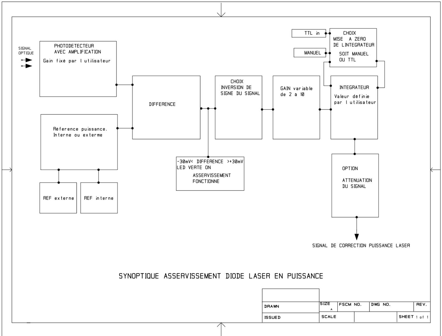
SYNOPTIQUE ASSERVISSEMENT DIODE LASER EN PUISSANCE
