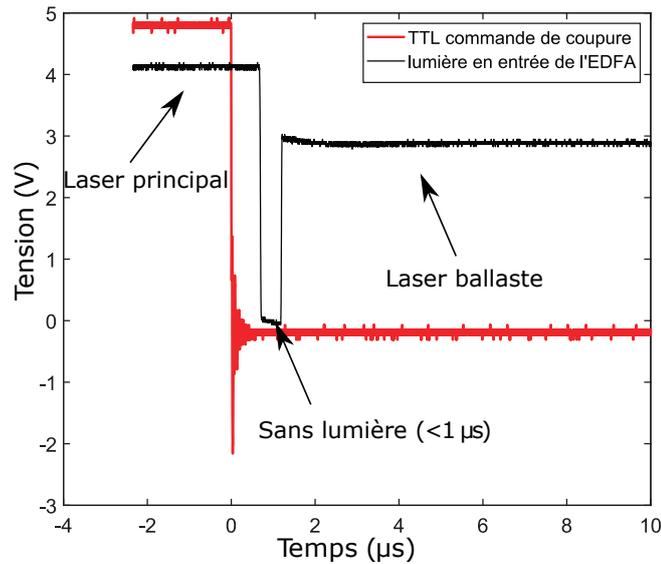
FIGURE 2.3 – Mesure sur un oscilloscope de la lumière en entrée de l’EDFA. Après coupure du laser principal, le laser ballaste s’allume avec un temps de réaction inférieur à la  $\mu\text{s}$  ce qui empêche la coupure de l’EDFA.
