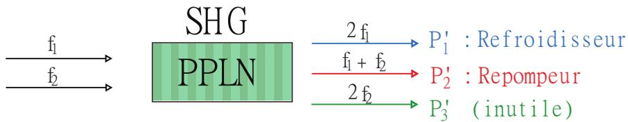
FIGURE 2.10 – Génération des fréquences de refroidissement de la transition D1. Dans ce cas, les trois composantes sont le refroidisseur, repompeur et inutile respectivement.
