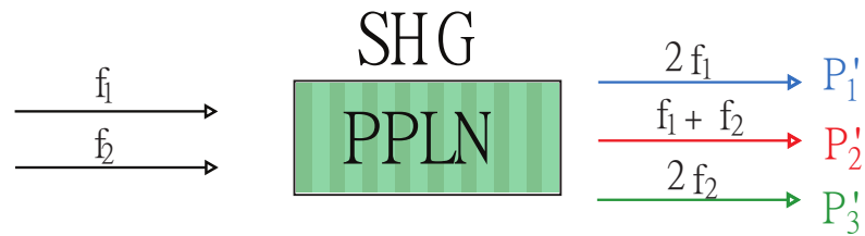
FIGURE 2.6 – Génération des fréquences de refroidissement de potassium : le processus non linéaire génère la deuxième harmonique de chaque fréquence et leur somme de fréquence.
