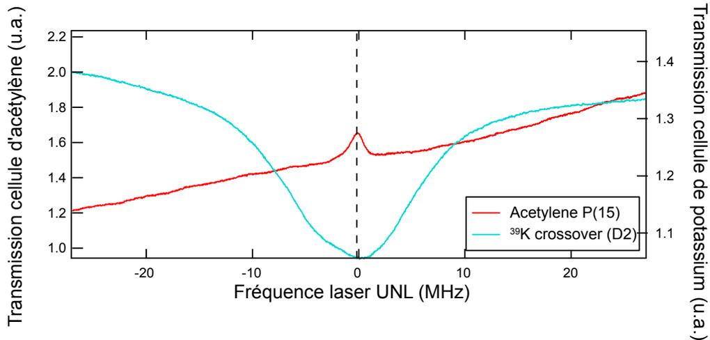
FIGURE 3.10 – Calibration de la fréquence et de l’harmonique du modulateur de phase pour superposer le cross-over de la transition D2 du  $^{39}\text{K}$  (en cyan) avec la ligne d’absorption P(15) de l’acétylène (en rouge). Nous utilisons la sixième harmonique du modulateur de phase avec une fréquence appliquée de  $15,119 \text{ GHz} \pm 1 \text{ MHz}$ .
