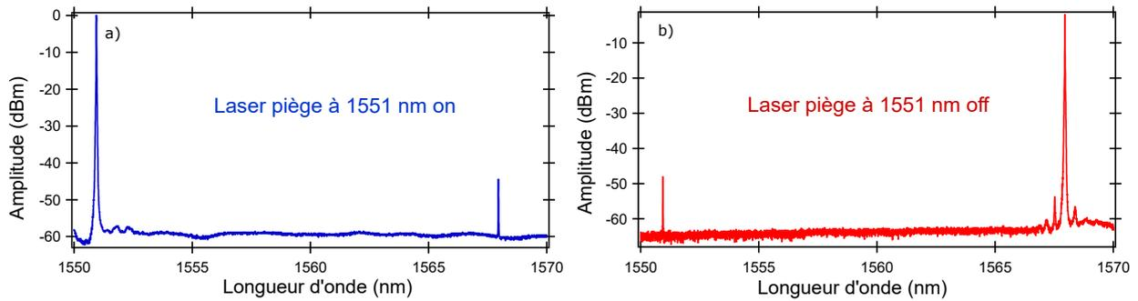
FIGURE 4.7 – Mesure sur l'analyseur du spectre optique du faisceau avant EDFA : (a) : le laser piège est à pleine puissance. L'asservissement 1 coupe le laser ballaste. (b) : le switch RF de l'AOM2 est éteint et le laser ballaste s'allume automatiquement au maximum de puissance.
