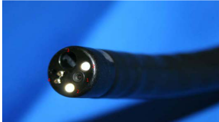
FIGURE 4.4 – Embout distal d'un gastroscopie. 1) Caméra. 2) Sources de lumière blanche. 3) Canal opératoire. 4) Canaux de nettoyage.
