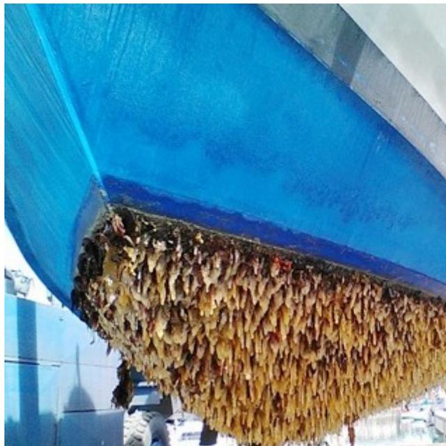
FIGURE II.2 – Biofouling sur la coque d'un bateau (www.wordpress.com).
