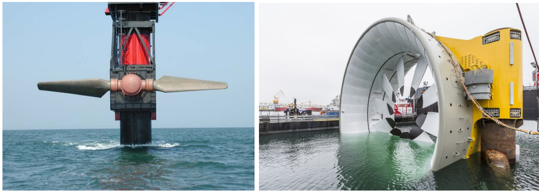
FIGURE I.3 – Démonstrateurs d'hydroliennes à axe horizontal avec (figure de gauche) et sans (figure de droite) moyeu central. Le premier est fixé à un mat tandis que le second est posé au fond de l'eau.
