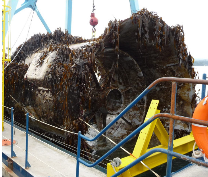
FIGURE I.6 – Hydrolienne à centre ouvert à axe horizontal après trois ans d’immersion dans la réserve naturelle de Race Rocks en Colombie-Britannique (Canada). D’après le site officiel de RaceRocks.
