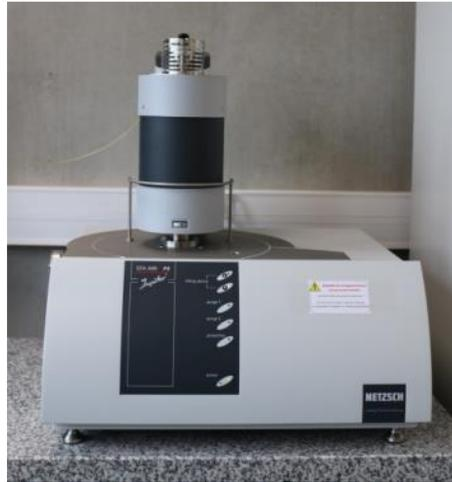
**Figure 23.** Thermo gravimètre de type STA 449 F5
