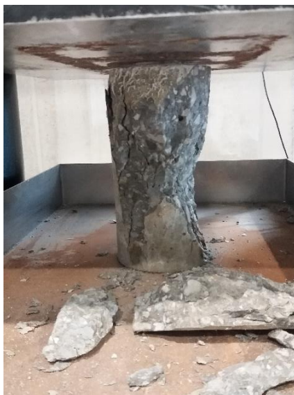
Figure 27. Essai de compression sur éprouvette de béton ( \varnothing 110 mm \times 220 mm) après 3 mois d'immersion in situ
