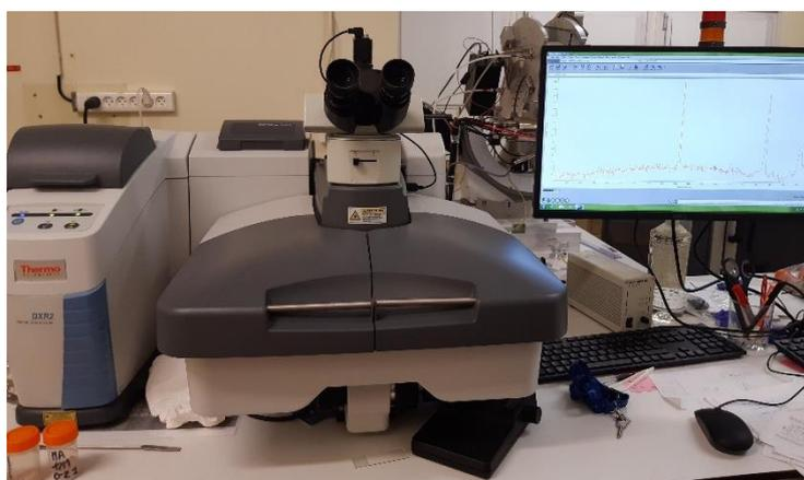
**Figure 25.** Spectromètre Raman
