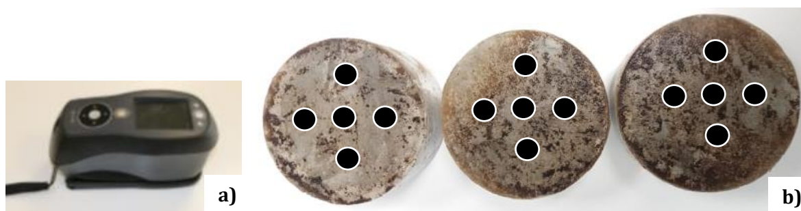
Figure 32. Spectrocolorimètre utilisé (Ci60 (X-Rite)) (a) ; disposition de l'emplacement des mesures au spectromètre réalisées (ronds noirs) (b)
