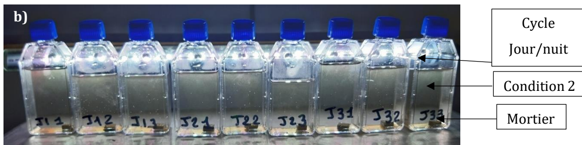
Figure 37. Dispositif expérimental de la dissolution du mortier immergé dans la condition 1 (a) et condition 2 (b).
