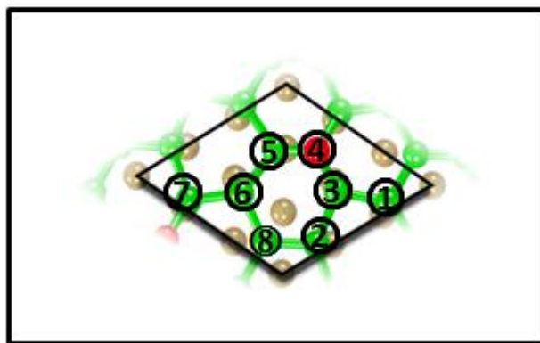
Figure III.1-14 : Modèle 1H qui correspond au contraste hexagonal (3x3) décrit par notre groupe, avec les numérotations des atomes de Ge pour faciliter la description des charges de Bader.
