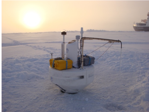
Figure 5. Photo de la plateforme IAOOS + SIMBA. Campagne TRANSARC II, RV/Polarstern, 2015.
