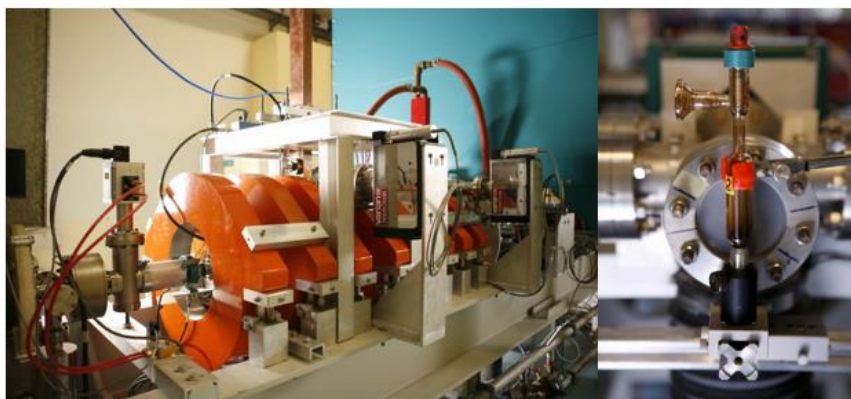
Figure 2.29. ALIENOR (à gauche) et ampoule contenant la poudre d'imogolite placée devant le faisceau d'électrons (à droite).
