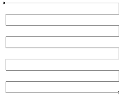
FIGURE 2.14 – Plan de vol schématisé pour assurer un recouvrement latéral entre les prises de vues de chaque ligne de vol.
