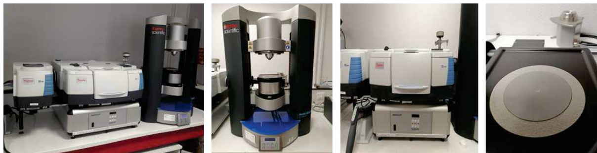
Figure 19 : Rheonaut HAAKE MARS 60 couplé à un spectromètre Nicolet iS50 FTIR de Thermofisher Scientific.
