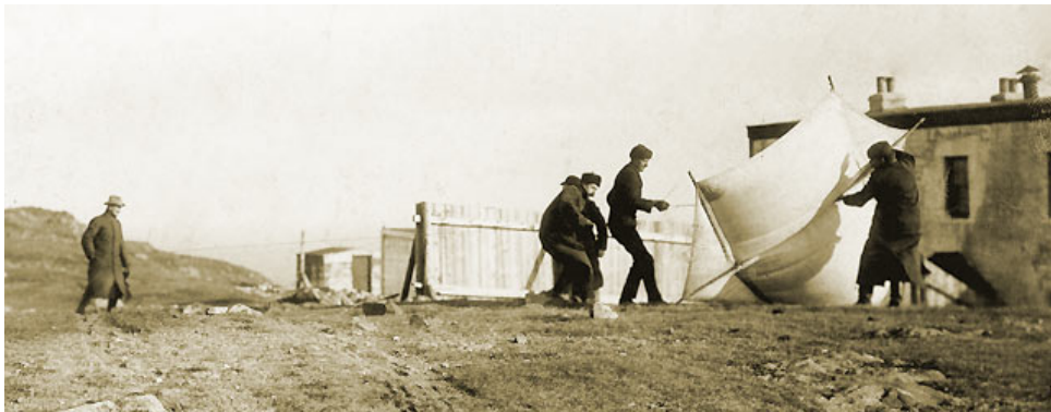
FIGURE 3.2 – Cerf-volant équipé d'un câble servant d'antenne de réception (@McClure's Magazine)
