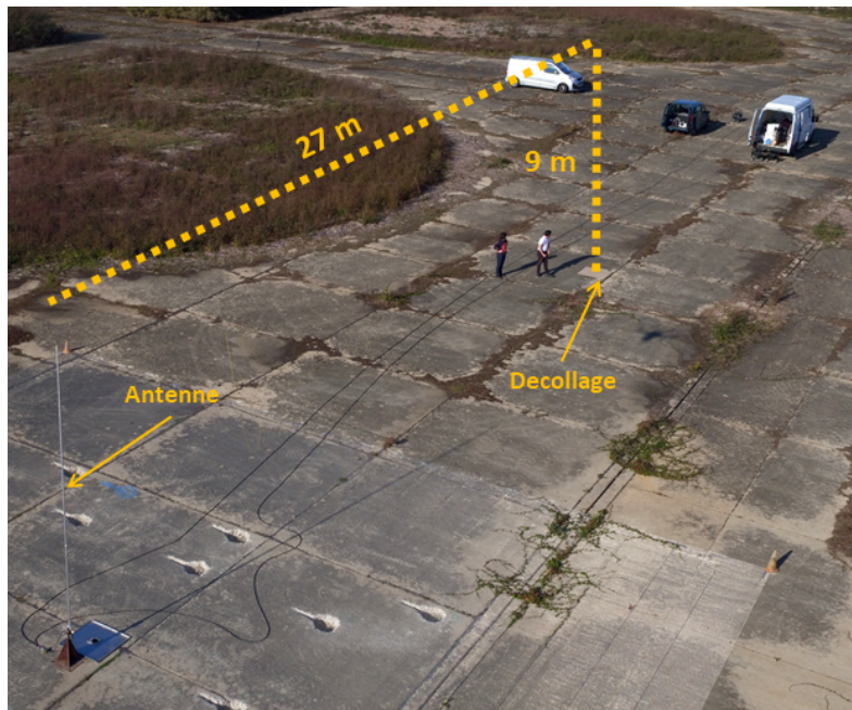
FIGURE 2.9 – Trajectoire du drone réalisée et site d'essai
