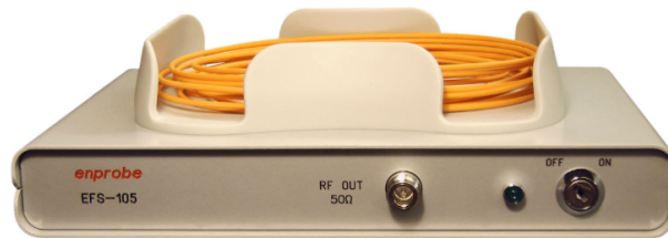
FIGURE 2.4 – Boîtier de sonde de champ proche d'enprobe
