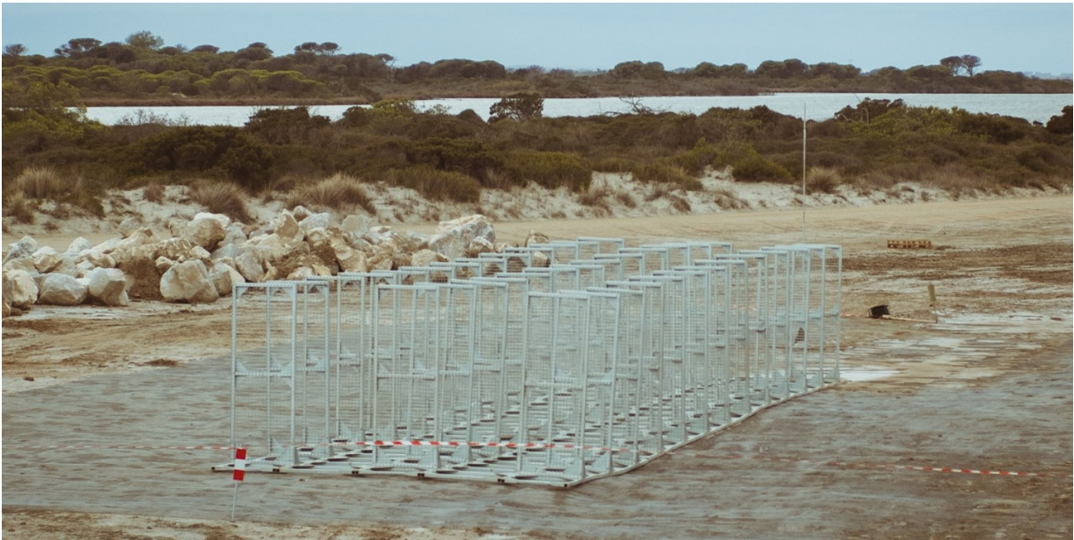
FIGURE 2.30 – Structure métamatériau installée aux Salins du Midi
