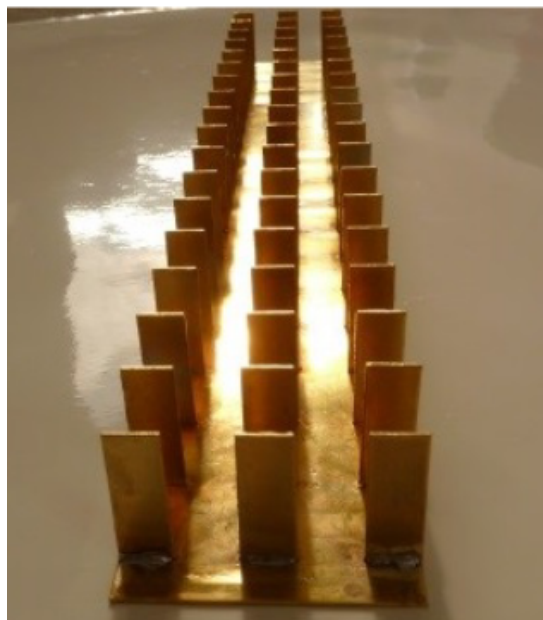
FIGURE 2.16 – Métastructure légère réalisée pour une fréquence de 1.1 GHz
