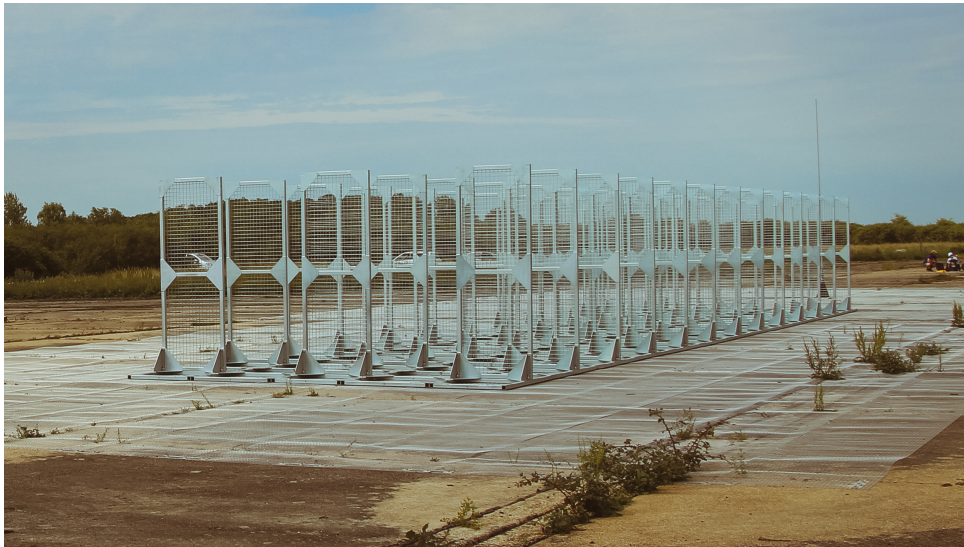
FIGURE 2.21 – Métamatériau et monopôle (au fond) servant d'excitation
