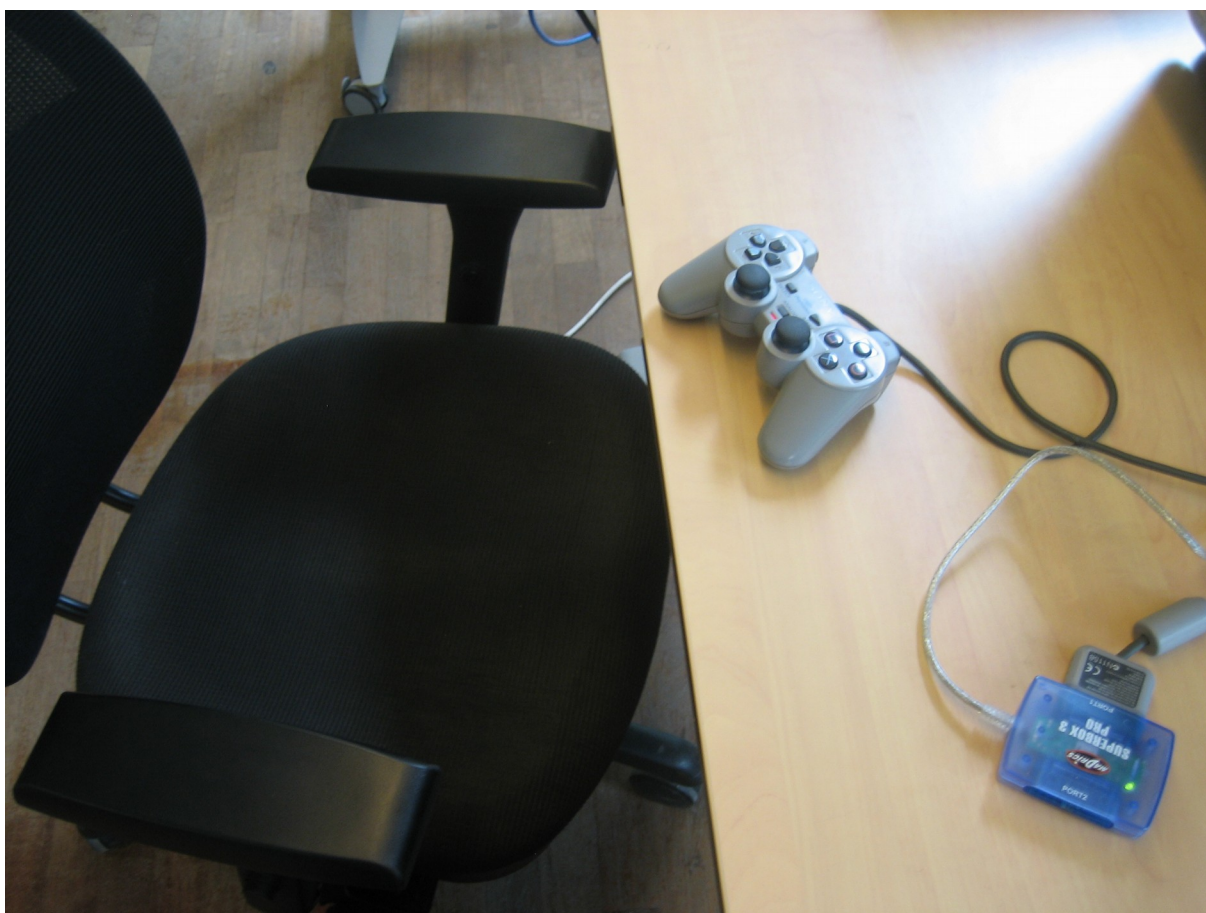
Illustration 43 : Fauteuil de réadaptation avec le premier dispositif de contrôle de l'avatar
