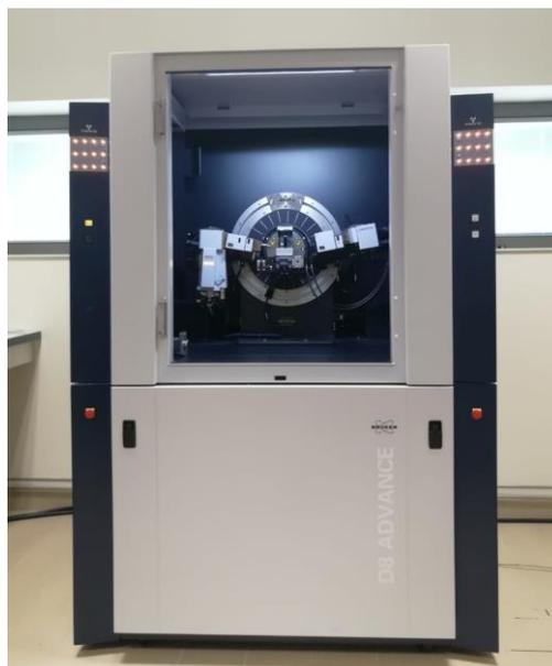
Figure III. 5 : diffractomètre à rayons X, Bruker D8 Advance.
