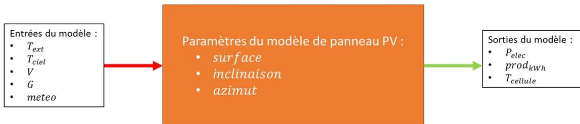
Figure 24 : Schéma-bloc du modèle de panneaux PV
