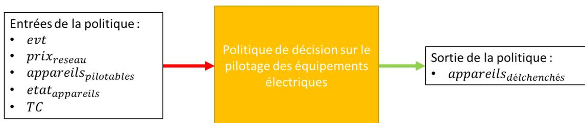
Figure 52 : Schéma-bloc de la politique de décision sur le pilotage des équipements
