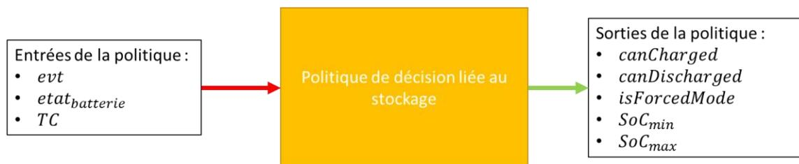
Figure 49 : Schéma-bloc de la politique de décision liée au stockage
