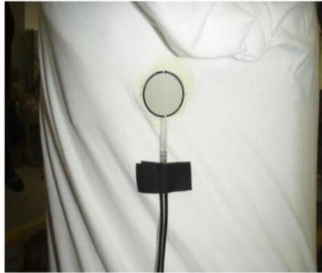
Figure 33 : Positionnement du capteur de pression
