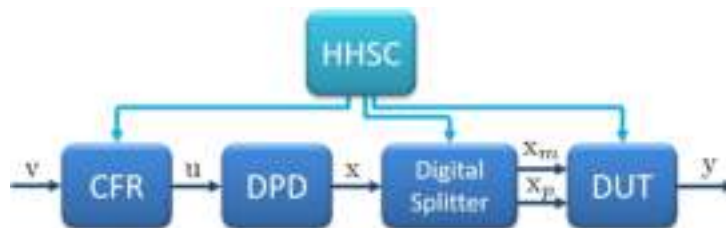
Figure 9 : Bloc diagramme de l'architecture proposée
