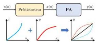
Figure 2 : Principe de la DPD
