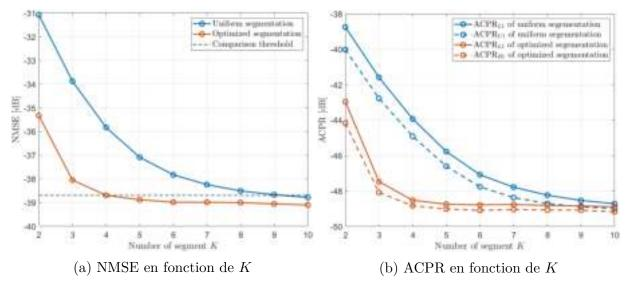
Figure 3 : Comparaison de la segmentation uniforme et la segmentation optimisée en fonction des performances de linearisation
