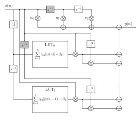
Figure 7: Implementation du modele DVR optimal par LUT
