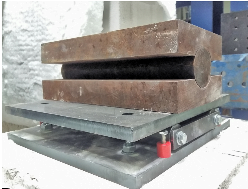
FIG. 5.8. : Pivot glissant de l'appui 1.
